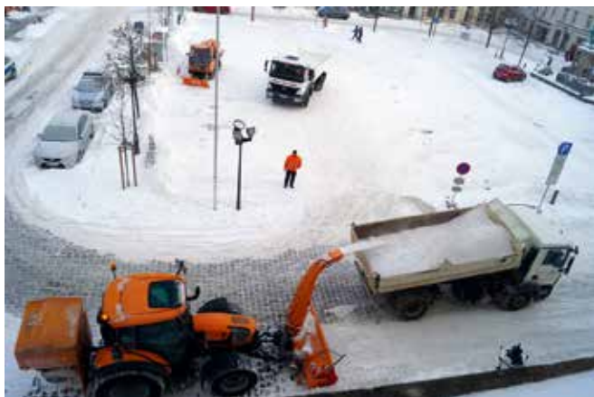
Einsatz der Schneefräse zum Abtransport der Schneemassen in der Innenstadt am 11.02.2021. Foto: Stadtverwaltung Großenhain/BS
